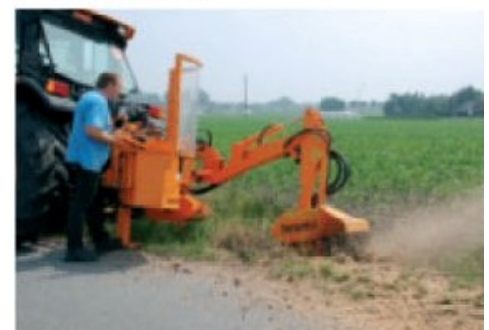
Optimale Sicht auf den Arbeitsablauf – der Anwender befindet sich hinter einem Plexiglas-Schutzschild.
