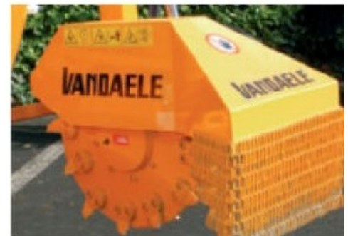
Das Fräsrads ist mit 24 austauschbaren Fräszähnen bestückt.
