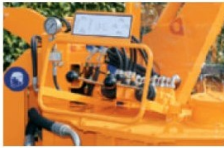
Standardmäßig mit Kreuzhebelsteuerung an der Maschinenseite ausgestattet.
