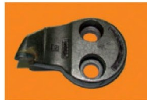
Die Fräszähne sind dünn mit WOLFRAM-KABID beschichtet.
