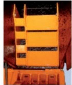
TV22-32 P; sistema de calibración de trituración (opcional).
