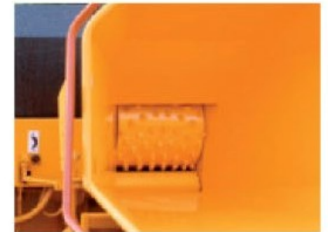
TV22-32 P; SUPER-AGARRE gracias al rodillo de alimentación superior con tachuelas (de serie).
