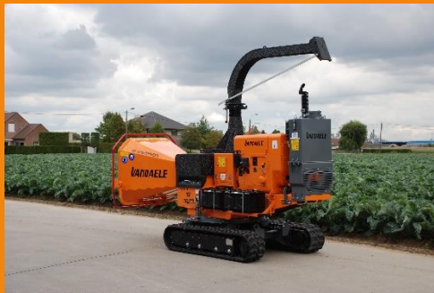
Hydraulisch angetrieben auf Raupen-Fahrgestell
