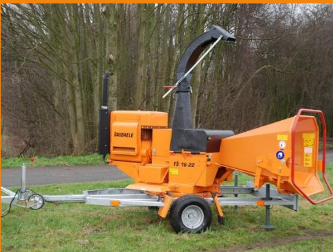
Auf Fahrgestell für Schnelltransport montierte Maschine, um 360° schwenkbar, (Option)
