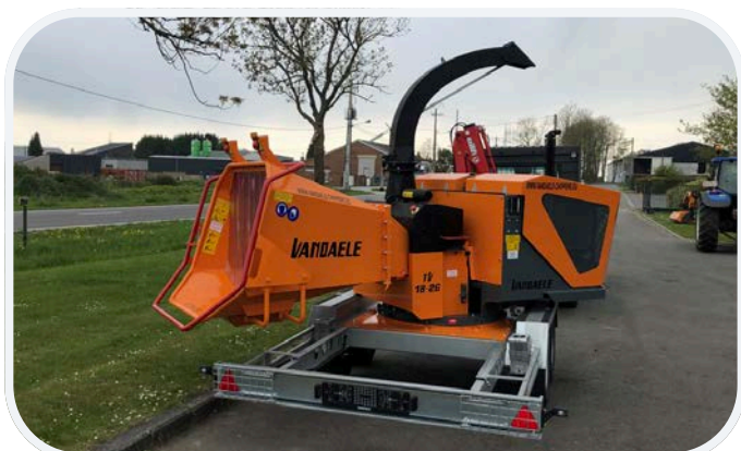
Machine uitvoering draaibaar op chassis met dubbele wielen en met dissel in hoogte regelbaar
